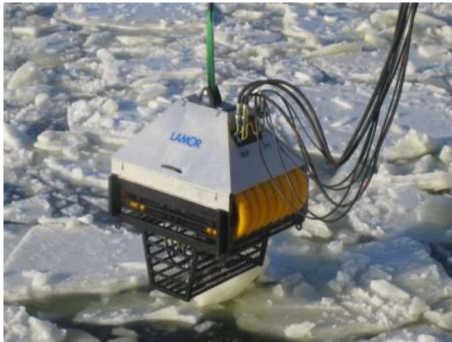
Fig. 15 Brush Arctic Skimmer LAS 125 W/P brush module
